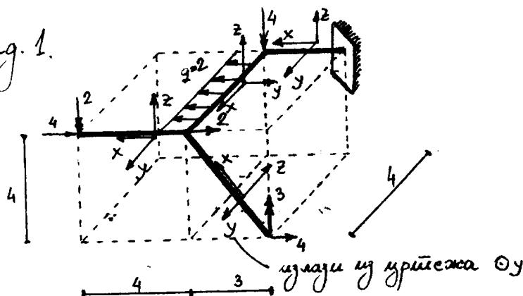
Решение: пошто имамо конзолу којемо са слободних крајева да дужиме  $N$  и  $M_z$  које речено у који работи којемо (који  $M_T$  знак се одређује као нормална сила)  $T_x, M_x$  дужиме паралелан са  $y$ -осом  $T_z, M_y$  - дужиме паралелан са  $z$ -осом
