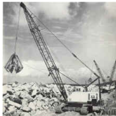
Zahvatna kašika sa mehaničkim prenosom
