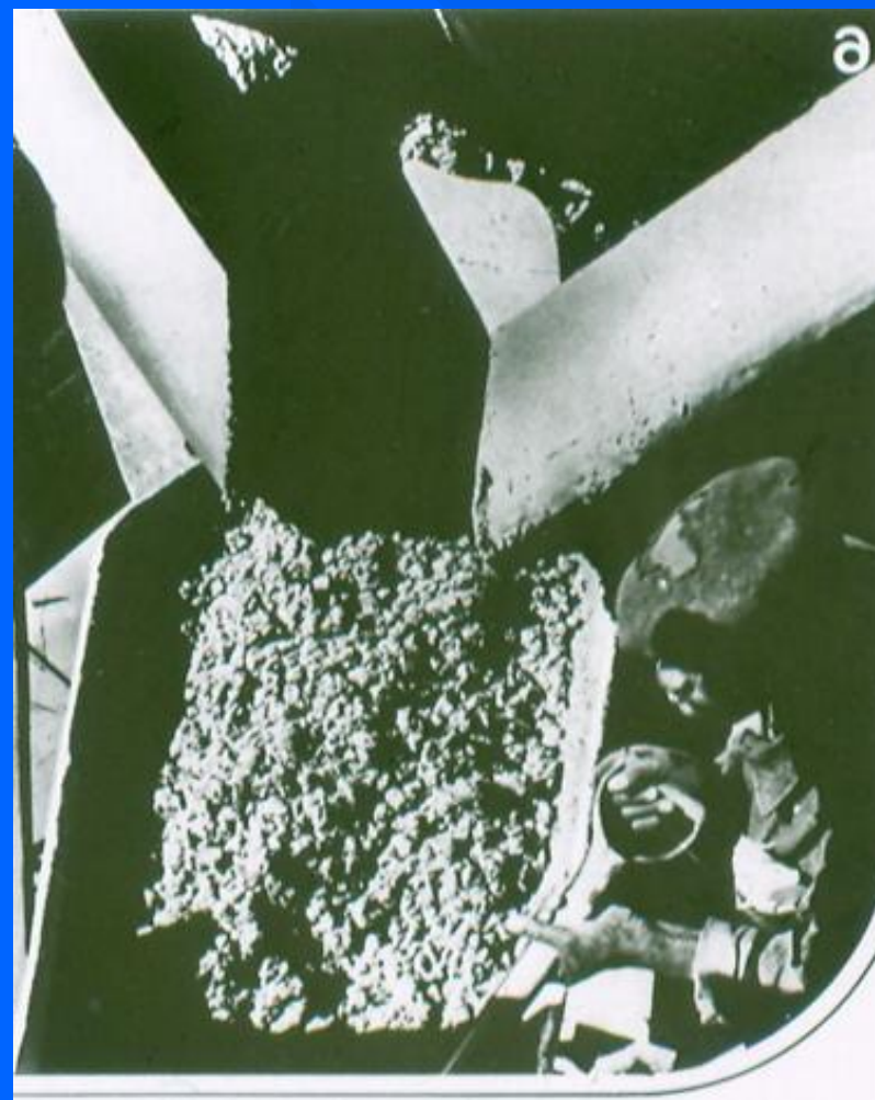
Uzimanje uzorka svežeg betona iz automiksera
